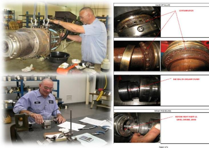
Todos los aspectos del husillo se monitorean para detectar un desgaste crítico con vibración y temperatura medidas a las RPM máximas. Se toman videos para cada huso durante la prueba final.
